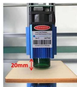
1. Положите измерительную алюминиевую колонну на поверхность гравированного объекта, ослабьте винт-барашек за лазерным модулем и переместите лазерный модуль на колонну.
