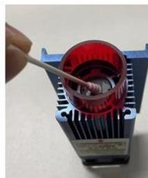
1. Фокусное расстояние лазерного модуля SCULPFUN фиксировано и не может быть изменено. Оно находится на расстоянии 20 мм прямо под краем алюминиевого корпуса лазерного модуля.
