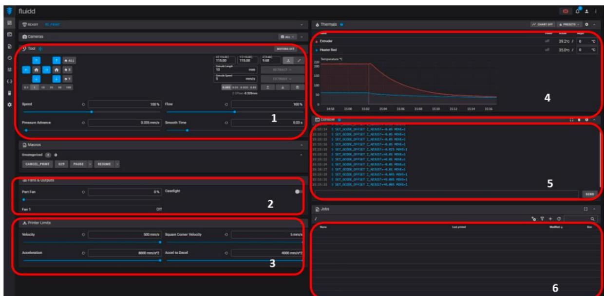
1. Управление головкой: обеспечивает возможность контролировать движение печатающей головки принтера вдоль каждой оси управления и устанавливать компенсацию после процесса выравнивания;
